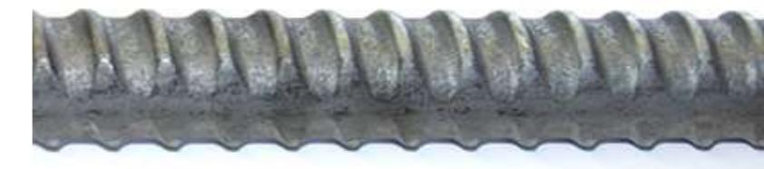
Stahlbauteile können überdimensioniert eingebaut werden, um den Querschnittsverlust beim „Abrosten“ zu kompensieren. Abhängig vom Baugrund können entspr. DIN EN 1993-5:2010 Tab. 4-2 folgende Werte angesetzt werden:
