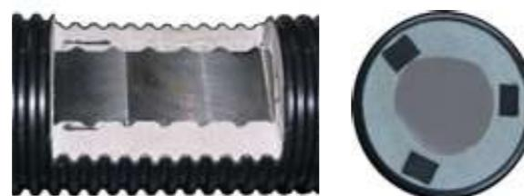
SAS Zuganker werden in einem Ripprohr liegend mit einem Zementmörtel ausinjiziert. Um die mittige Lage des Zugankers im Ripprohr zu gewährleisten, werden Abstandshalter eingesetzt. Doppelt- Korrosionsgeschützte Zuganker können auch in aggressiven Medien eingesetzt werden.
